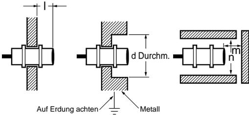
\* Stellen Sie sicher, dass das Metallobjekt ferromagnetisch ist, da der E2K-Q-X sonst nicht stabil betrieben werden kann.
