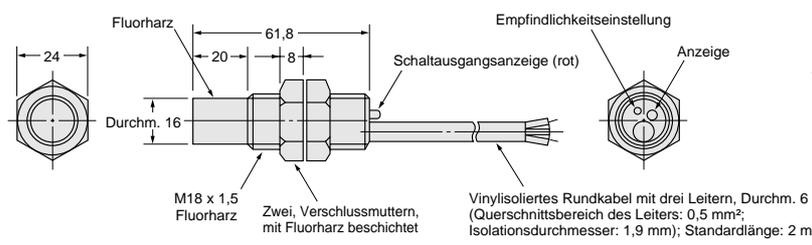
Abmessungen für die Befestigung
