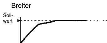
Es ist möglich, Schwankungen, Überschwingungen und Unterschwingungen zu unterdrücken. Dazu ist allerdings eine vergleichsweise lange Anfahrzeit erforderlich.
