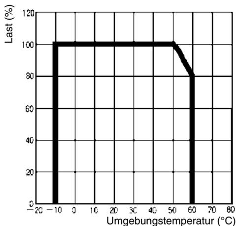
Für UL und CSA beträgt die Maximaltemperatur 50 % (bei Reduktion um 2 %/°C von 40 bis 50°C, nur 40-A-Modell).
