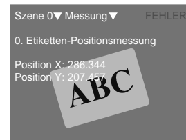
Testmessung erfolgt im Vergleich mit vorherigem Fehlerbild.
