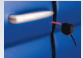
Messung des Türspalts
