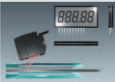
Bestimmung der Elektrodenlage bei Anzeigemodulen
