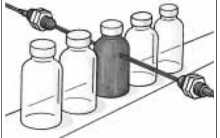
Erkennung kleiner Markierungen mittels eines Reflexionslichttaster-Lichtleiters E32-CC200
