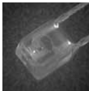
Hyper-LED: punktförmige Lichtquelle mit intensivem Lichtstrahl (Wellenlänge: 670 nm)
