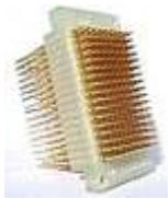
Interne VG-Block-Schnittstelle, 170polig mit verschiedenen Anschlussmöglichkeiten
